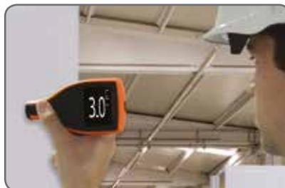
Pantalla con giro automático de 360° para una lectura clara en cualquier ángulo de medición, en la línea de producción o estación de QA.
